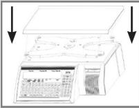
Para verificar se a balança está corretamente nivelada, utilize um nível do tipo carpinteiro sobre o prato de pesagem da balança. Sendo necessário alguma correção, ajuste os pés reguláveis da balança. Abra a tampa da impressora e retire o calço de papelão do mecanismo da impressora.
