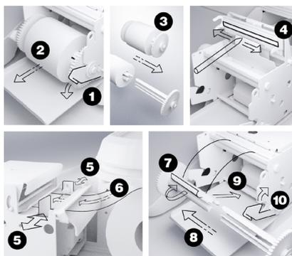
**Passo 1:** Abaixar a alavanca de trava do rebobinador e puxar a impressora para frente até que ela saia do interior do gabinete da 7T. A impressora desliza sobre um guia no chassi da balança, permitindo movimentação para dentro e fora do gabinete da balança. Durante o uso a impressora deverá estar posicionada dentro da 7T. A mobilidade da impressora é travada pelo encaixe da trava esquerda do liner no orifício existente no chassi da 7T (lado esquerdo da impressora);
