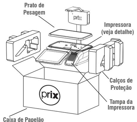
Após retirar a 7T da caixa de papelão, remova a tampa da impressora e retire o calço de papelão do mecanismo da impressora.
