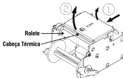
Passa a caneta transversalmente sobre a superfície da cabeça térmica.
