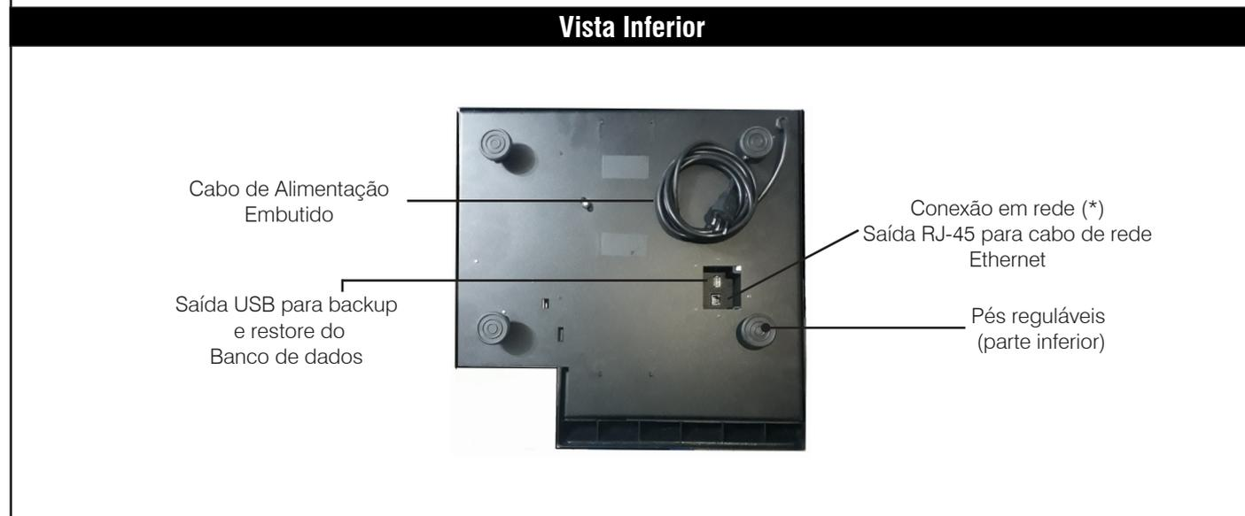
(\*) Além da comunicação via Cabo Ethernet 10 BASE-T/100-BASE-TX a balança 4 Due possui comunicação Wi-Fi Padrão 802.11b, 802.11g e 802.11n, com frequência de 2.4 GHz. Criptografia WEP 40/64 ou 128 bits, WPA-PSK TKIP e WPA2-PSK AES.
