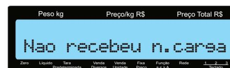
A primeira mensagem indica o número de carga local que a balança possui. O contador só funcionará quando a balança estiver operando em rede com o MGV 6 e MGV Cloud
