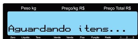
Na sequência, o MGV atualizará automaticamente o cadastro de itens da balança e, durante o processo de atualização automática do cadastro de itens, será exibida a mensagem a seguir:
