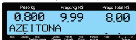
Com o display indicando o peso drenado, tecle
