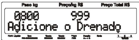
Com o display indicando o peso drenado, tecla
