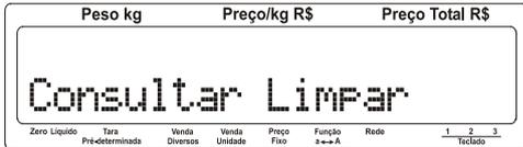
Utilize uma das três teclas , ou para selecionar a opção "Limpar" e em seguida tecle com "Limpar" piscando.
