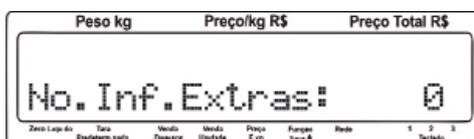
Tecla **Entra** e será exibida a quantidade de fornecedores cadastrados na balança (quando gerenciada pelo MGV 6, MGV 6 Global e MGV Cloud) conforme tela a seguir:
